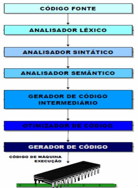
Figura 2 - Fases de um processo de compilação [4]
