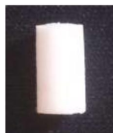
(b) amostra de Teflon usada para ensaio em RF.
