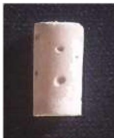
(a) amostra de pasta de cimento usada para ensaio em RF.
