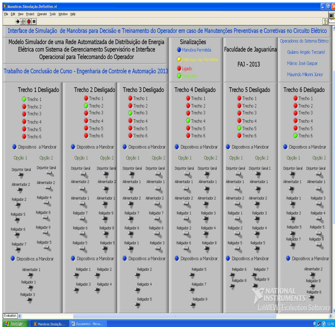
Figura 4: Detalhe do Sistema de Gerenciamento Supervisório para Simulação de Manobras dos Dispositivos de Operação e Proteção de maneira virtual pelo Operador do Sistema.
