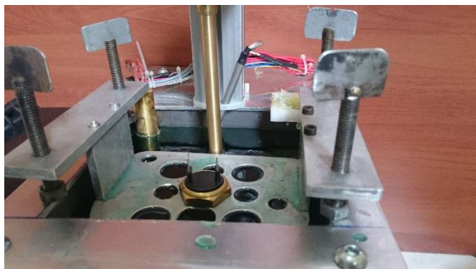
Figura 3 – Tanque termocirculador para aquecer interruptor térmico. (FONTE: Autor)
