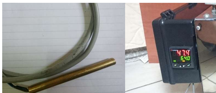
Figura 9 – Sensor e controlador de temperatura (FONTE: Autor).
