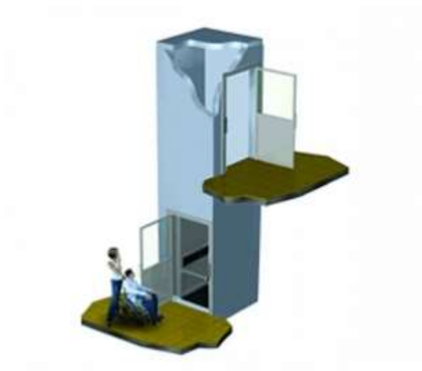
Figura 3: Plataforma elevatória com abertura adjacente.
