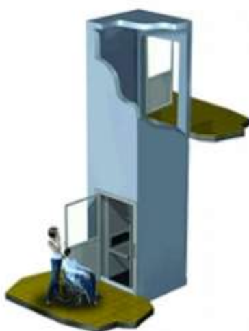
Figura 2: Plataforma elevatória com abertura oposta.
