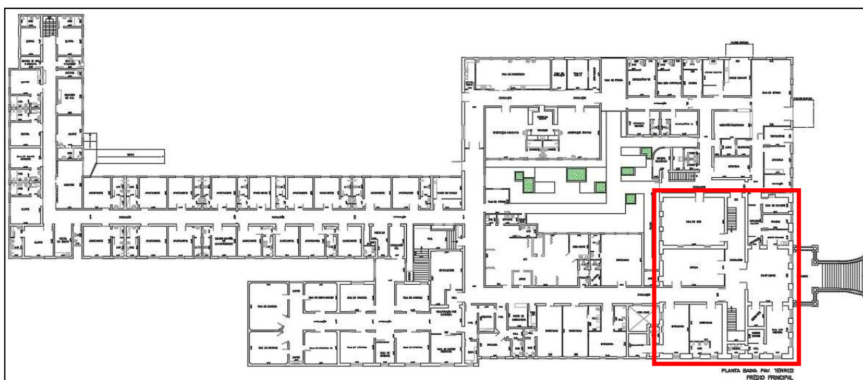
Figura 10. Área Demarcada Demonstra Provavelmente A Utilização De Alvenaria De Adobe, Planta Térrea Do Prédio Principal Sem Escala.
