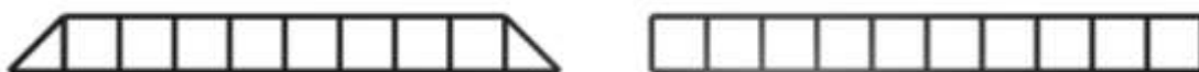
Figura 2. Esquemas da viga treliçada Vierendeel e da viga Vierendeel estudadas com vão de 30 metros.
