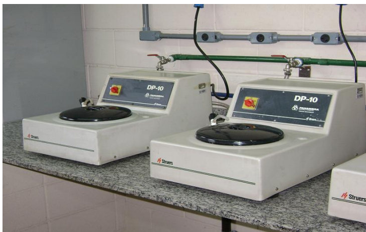
Figura 5. Ilustração das politrizes utilizadas no lixamento.
