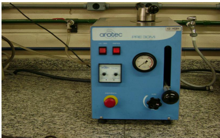
Figura 4. Ilustração da embutidora utilizada.
