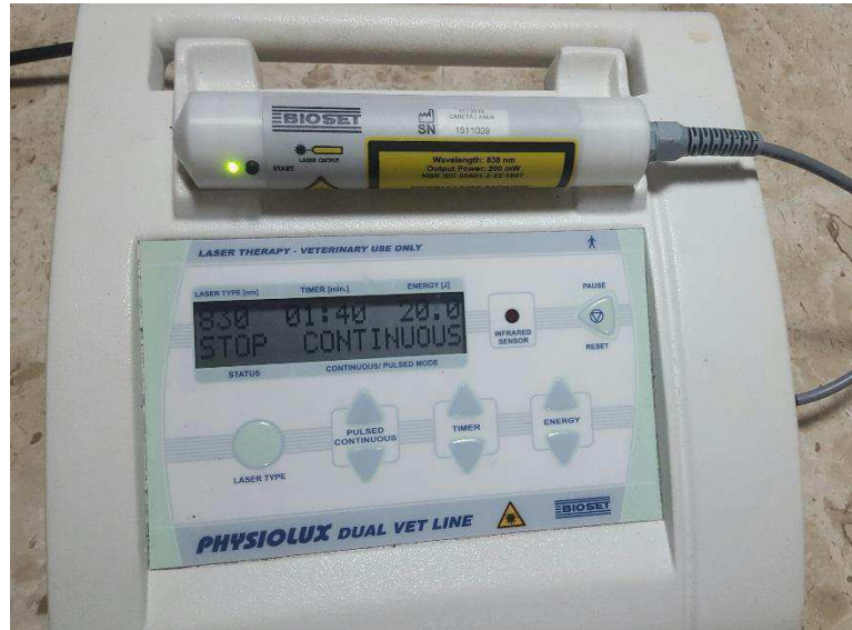
Figura 11. Laser terapêutico, fabricante Bioset, modelo PHYSIOLUX DUAL VET LINE. Fonte: Elaborada pela autora
