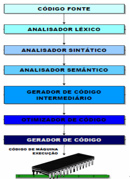
Figura 2 - Fases de um processo de compilação [4]
