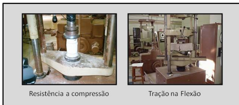
Figura 4 – Ensaios realizados com o Concreto Ecológico (Fonte: Via Viva)
