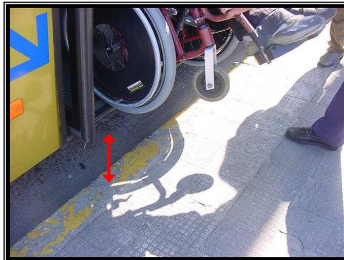
**Figura 1** – Ônibus carroceria Caio com plataforma de acesso para deficientes que não chega ao nível da rua.
