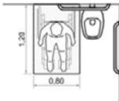
Figura 276 – Transferência lateral em sanitários Fonte: NBR 9050 (2004)
