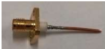
FIG. 2 CONECTOR SMA FÊMEA COM O EXCITADOR DE RADIOFREQUÊNCIA SOLDADO.
