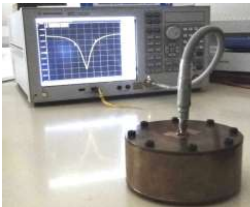
FIG. 4 ANALISADOR DE REDE COM CABO COAXIAL LIGADO À CAVIDADE RESSONANTE CILÍNDRICA
