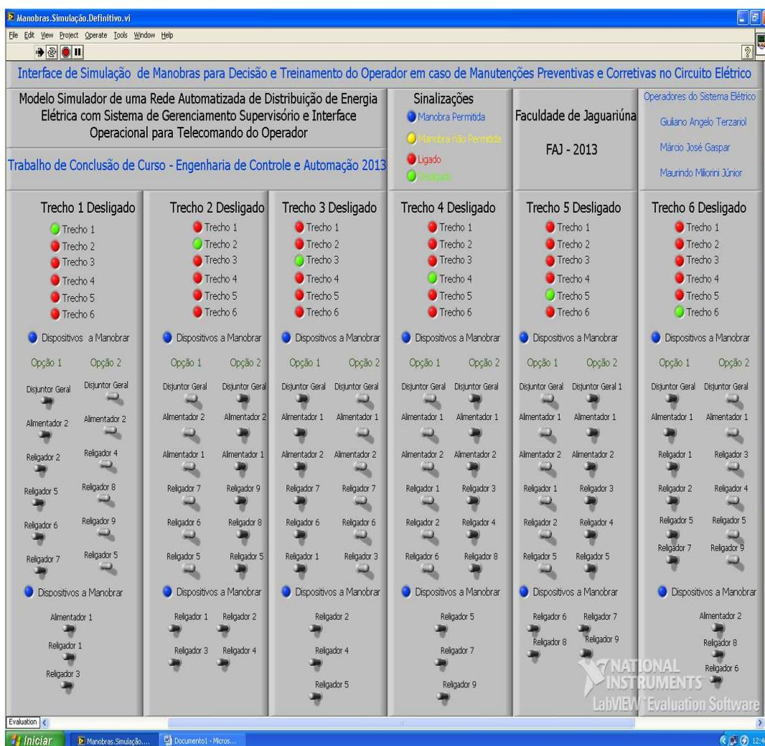
Figura 4: Detalhe do Sistema de Gerenciamento Supervisório para Simulação de Manobras dos Dispositivos de Operação e Proteção de maneira virtual pelo Operador do Sistema.
