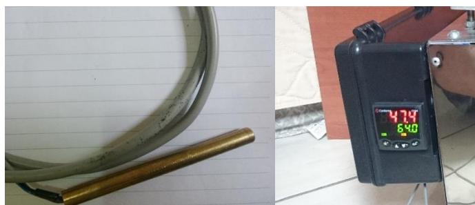
Figura 9 – Sensor e controlador de temperatura (FONTE: Autor).
