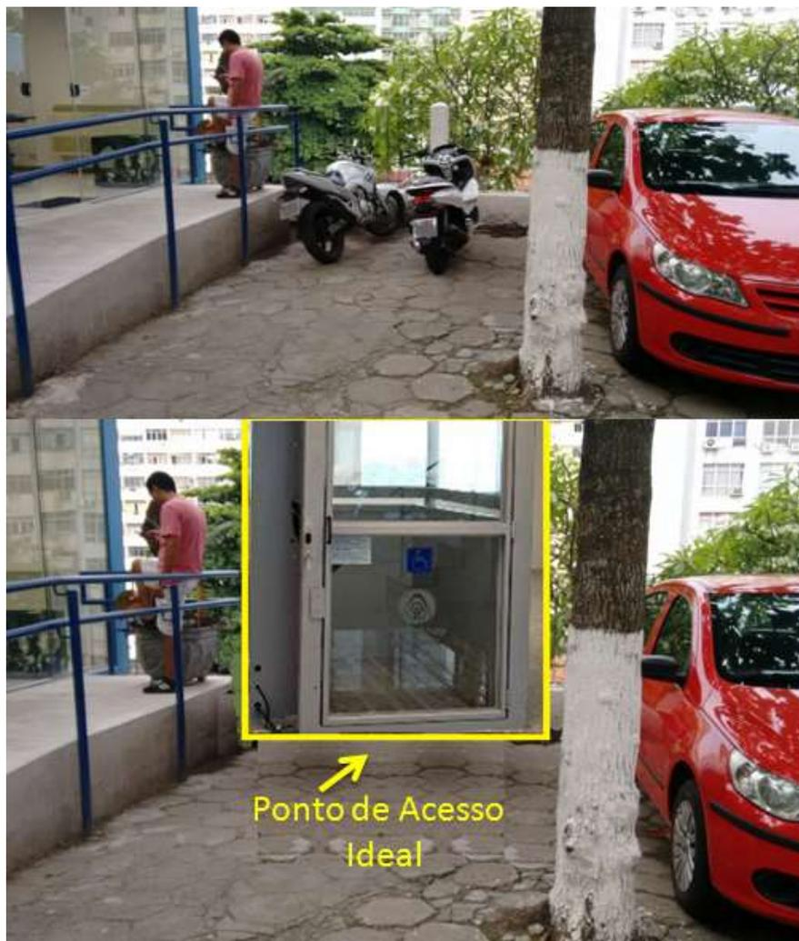
**Figura 8:** Ponto proposto para o acesso superior da plataforma elevatória.
