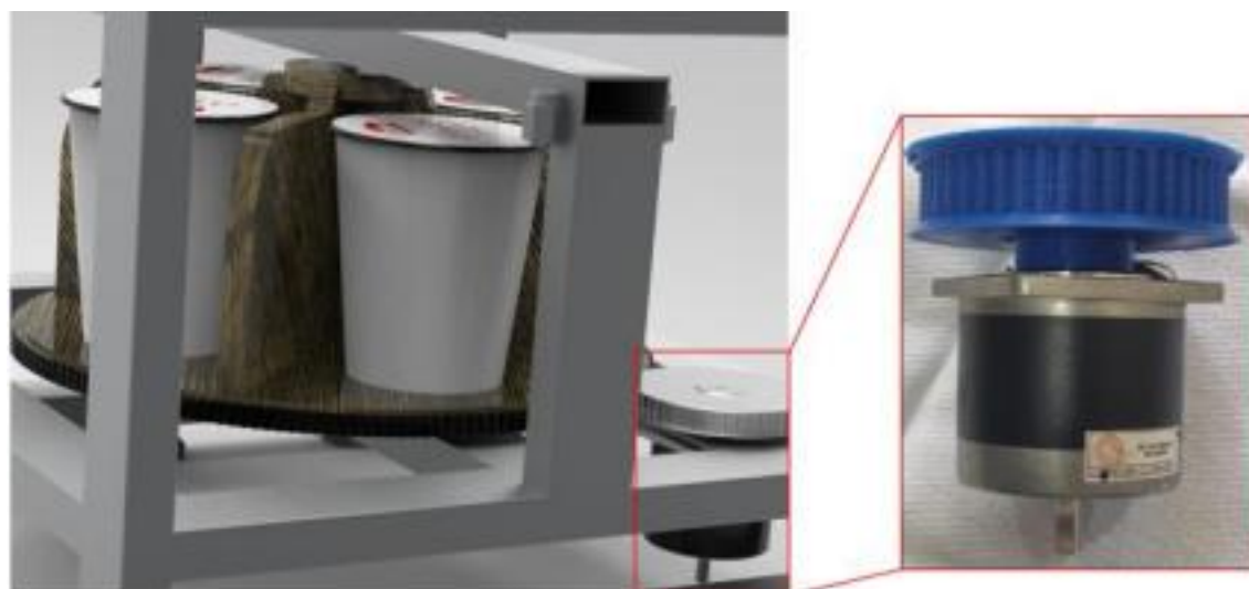
Figura 3: Carrossel de opções e mecanismo giratório
