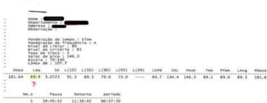
Imagem 02: RELATÓRIO EMITIDO PELO DOSÍMETRO INSTRUTHERM DOS 600 CONFORME O SEGUNDO CENÁRIO DE ANÁLISES
