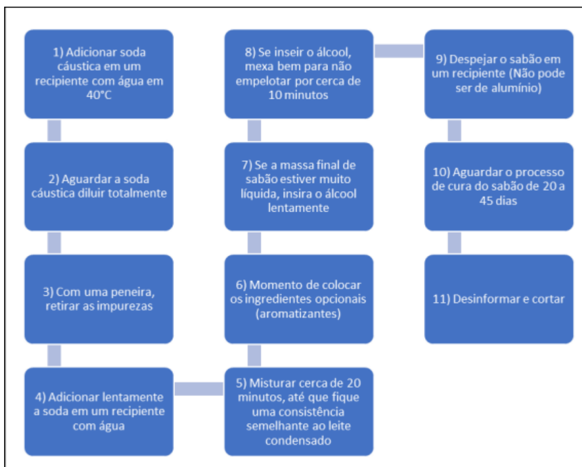
FIGURA 4 – FLUXO DE PROCESSO DE PRODUÇÃO SABÃO EM BARRA
