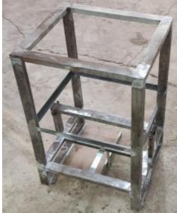
Figura 11: Estrutura de sustentação - Montagem
