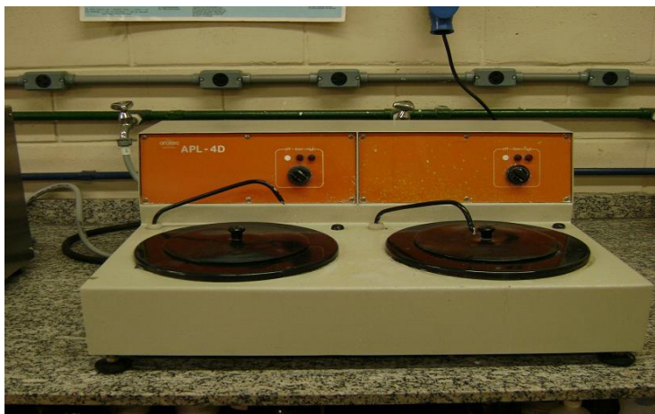
Figura 6. Ilustração da politriz utilizada no polimento.
