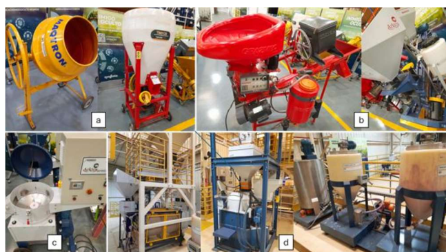
Figura 1: Equipamentos on-farm simples (a), on-farm com atomização da calda de fluxo contínuo (b), on-farm com atomização da calda de batelada (c) e utilizados no tratamento de sementes no sistema industrial de fluxo contínuo e de batelada com controle e dosadores individualizados dos produtos (d).
